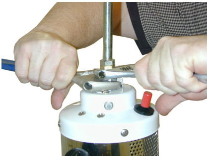
Figura 10 - Cómo apretar el tubo múltiple y el conjunto del quemador
